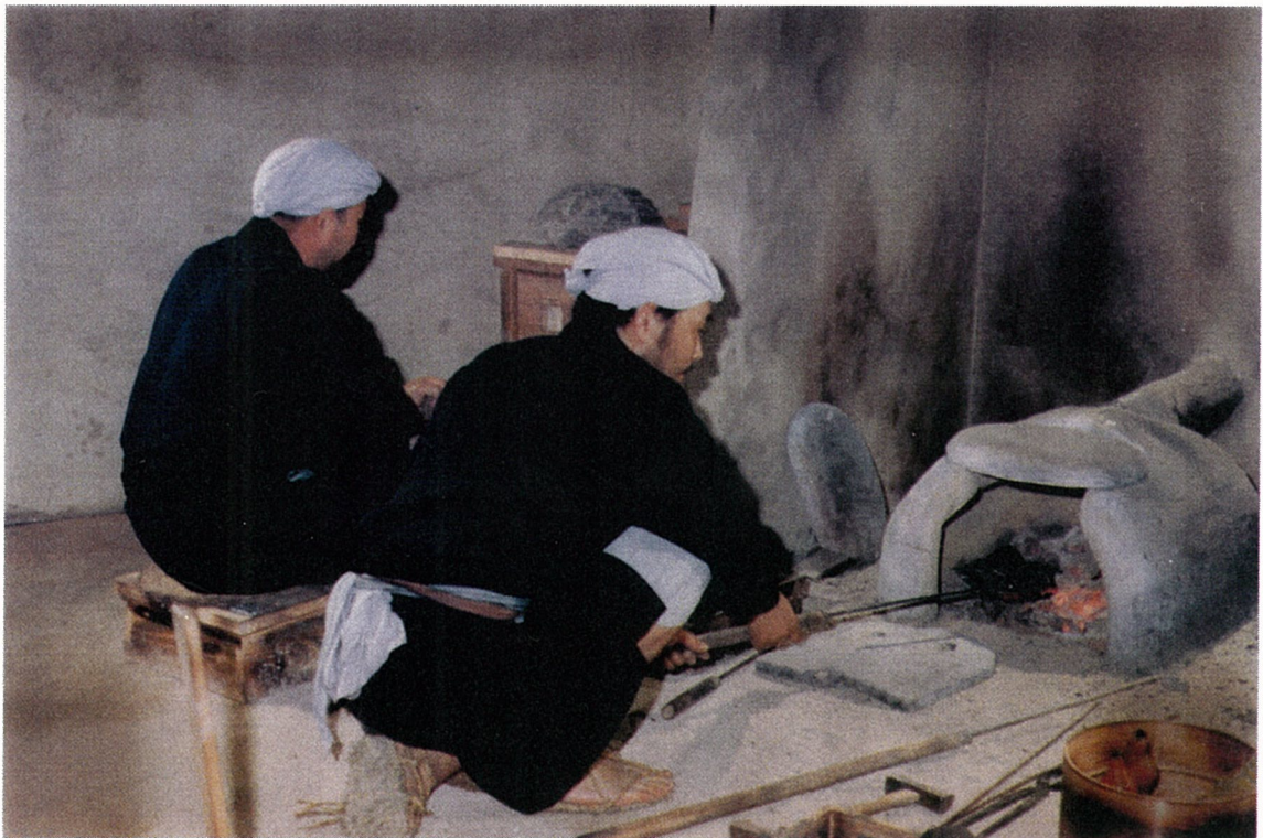
貴鉛装入 炭火をおこし、頃合いを見て貴鉛を装入する。
