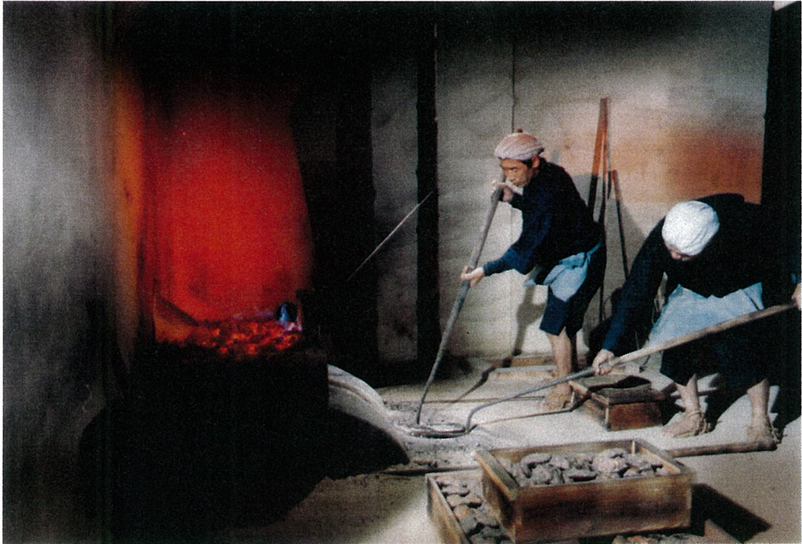
貴鉛冷却1 出尽くした貴鉛を、2名の共同作業で、冷却すべく、前炉から切り離す。
