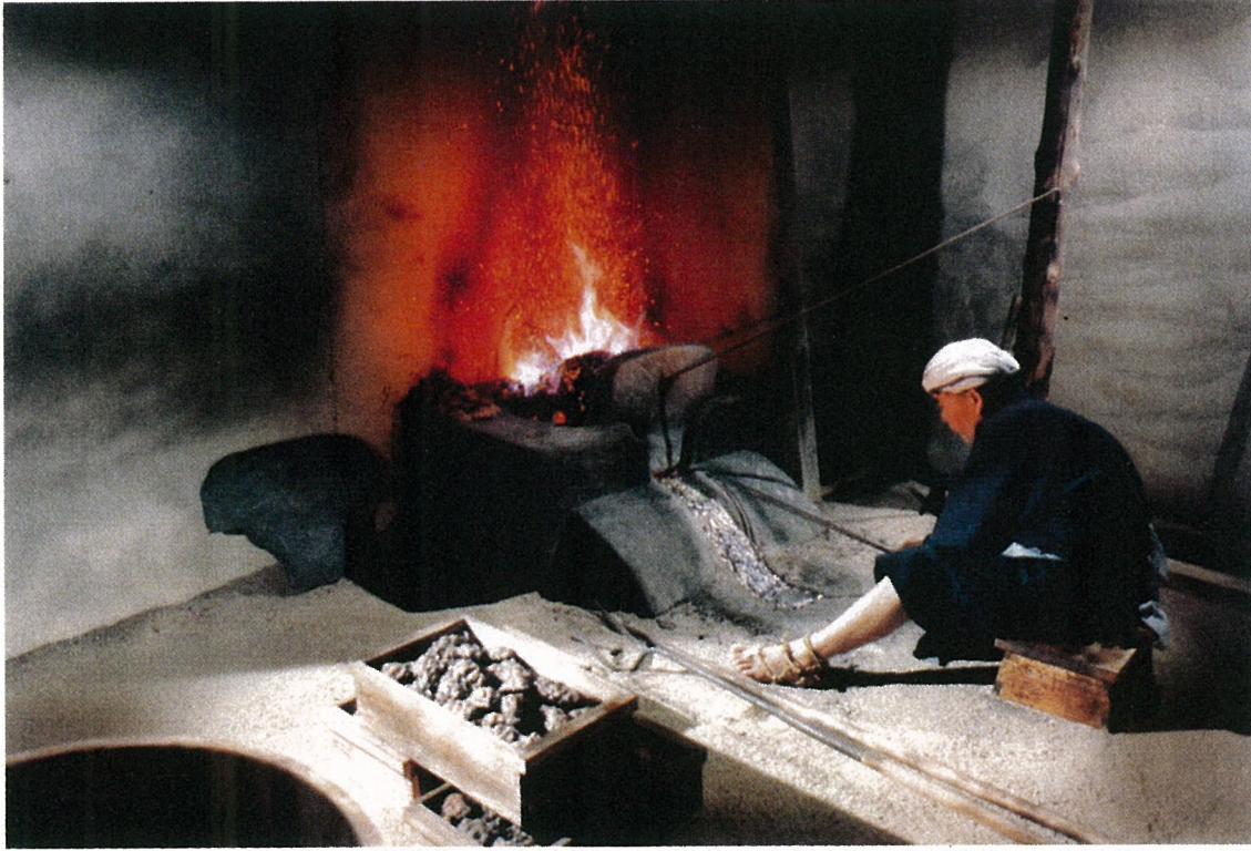
絞吹2 絞り出すことを繰り返す。この際前炉に出た銅は叩いて鉛を絞 り出し、炉内に押し込む。
