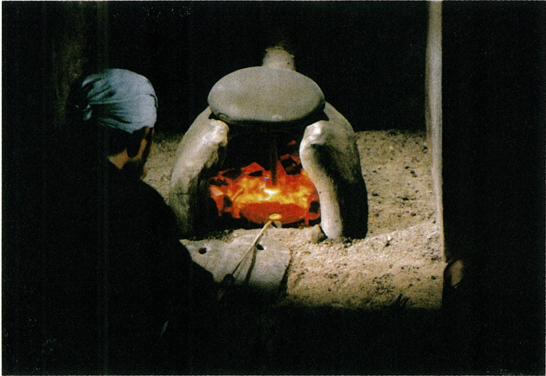
灰吹銀取り出し 仕上がった銀を炉床から取り出し、水中で冷却する。
