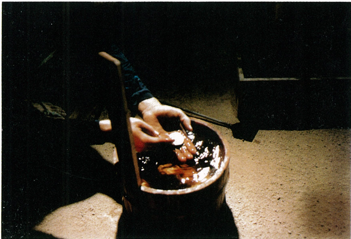
灰吹銀 水中で冷却した銀。銀の出来栄えは老練な熟練工の経験と勘がものをいう。
