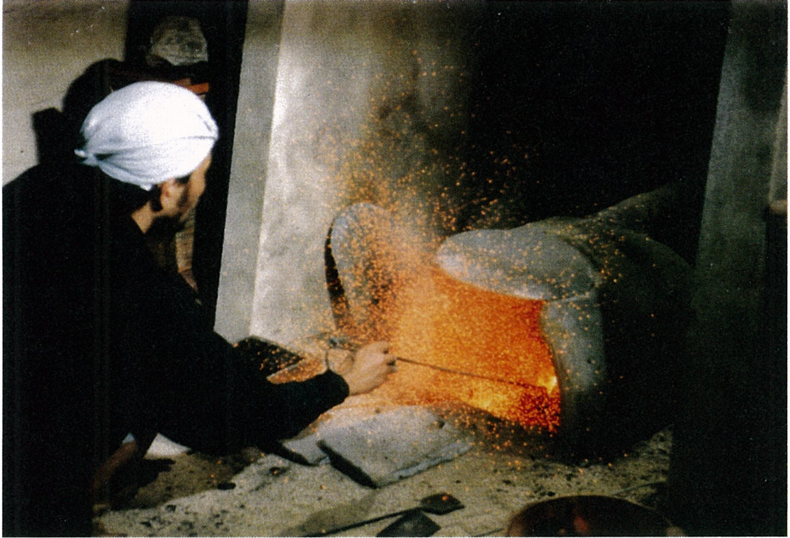
熔解 鞆の風を強め、貴鉛を熔解する。
