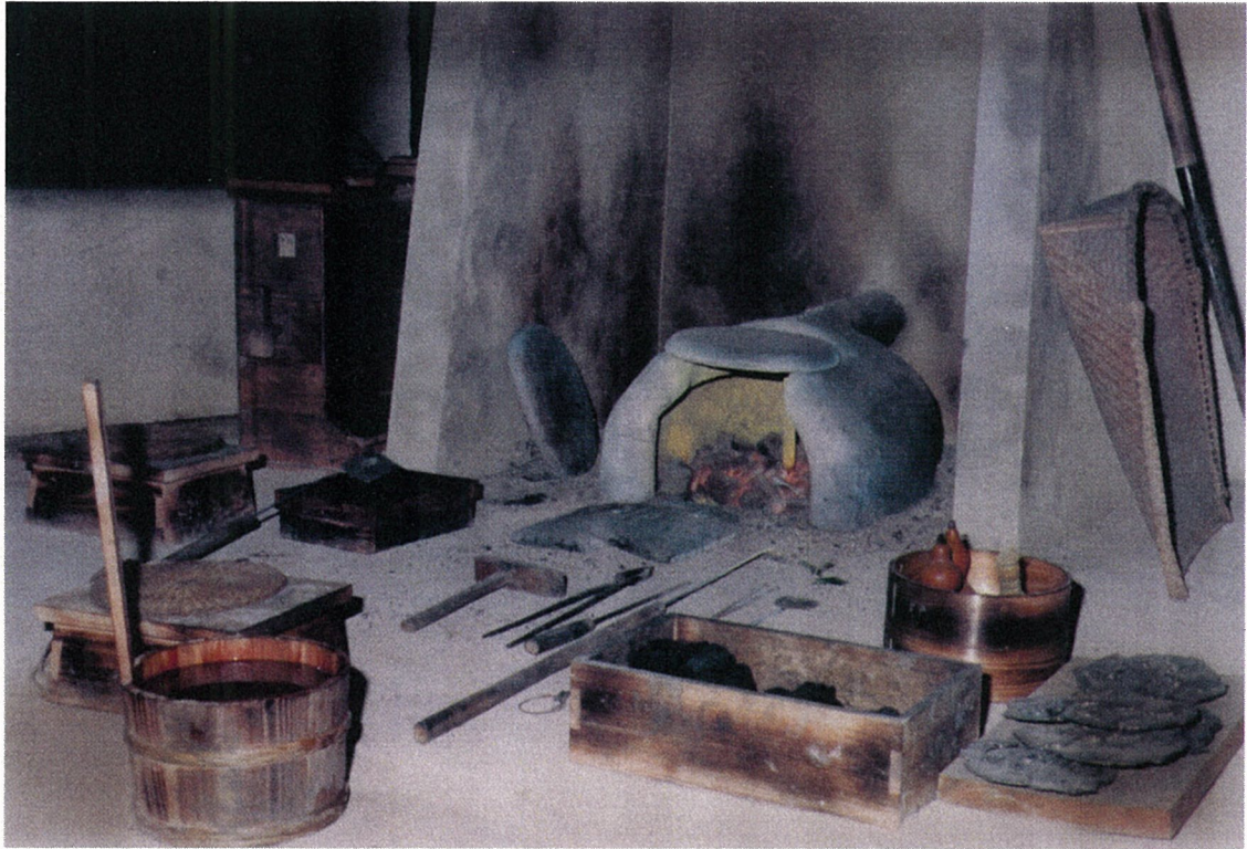
灰吹炉 炉の材質は南蛮炉に同じ。炉床は骨灰を打ち固めて作る。外寸幅一尺八寸、奥行二尺一寸、壁高一尺二寸。
