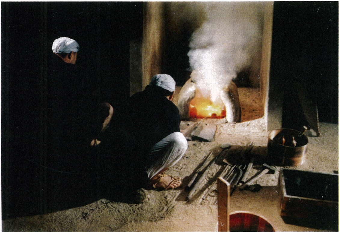
酸化・金詰め 熔解した貴鉛中の鉛は酸化され、さかんに煙が立ちのぼり、大半は密陀となって炉床に染み込む。続けるうちに煙が薄らぎ、炉床には銀が濃縮される（金詰め）。
