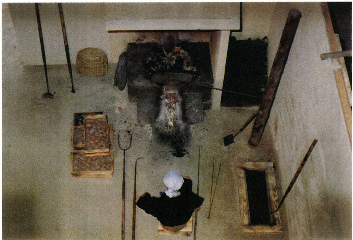
絞吹3 良い出鉛を得るためには、経験に培われた手腕がものをいう。 貴鉛の出尽くした銅は海綿状となり、炉内に残る（絞銅）。
