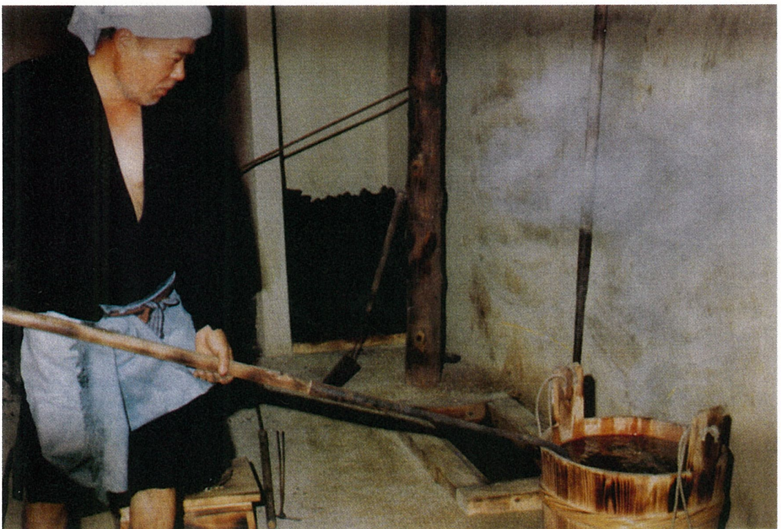
貴鉛冷却2 貴鉛を水中で冷却する。
