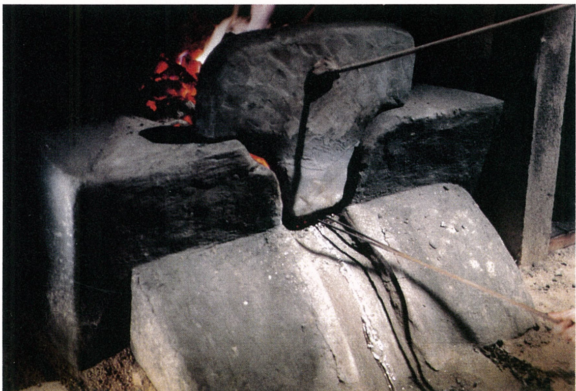
絞吹1 炉に合銅を装入し、木炭（櫟）を充填・加熱して、合銅を半熔融に保ち、金銀を含有する鉛（貴鉛）を前口から絞り出す（出鉛）。
